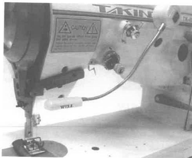
**A974M** faretto a Led magnetico e posizionabile ovunque, **trasformatore incorporato**. studiato per evitare al massimo le vibrazioni dovute alla macchina
